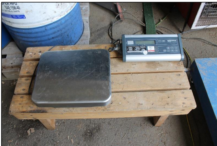
Kuva 4. Lajittelun jälkeen tehtiin uusi punnitus jätelajeittain pienemmällä vaa'alla.
