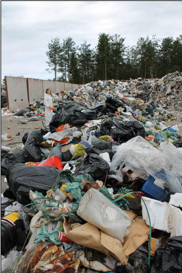
Kuva 1. Jäteauto pudotti kuorman pitkäksi kasaksi, joka jaettiin narun avulla kahteen kasaan. Kummastakin kasasta otettiin yksi näyte.
