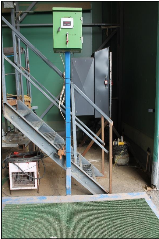
Kuva 3. Iso vaaka, jolla punnittiin näytteet isossa jäteastiassa ennen lajittelua.
