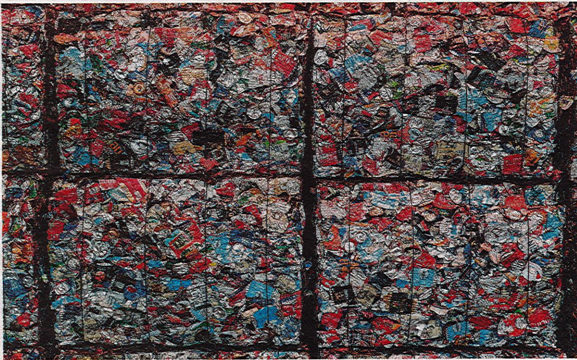
Yhteen tölkkipaaliin on puristettu noin 400 000 juomatölkkiä.
