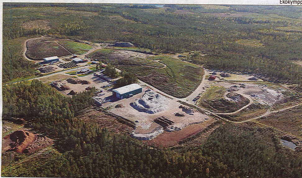
Majasaaren jätekeskuksessa otetaan vastaan kainuulaisten tuottama rakennusjäte sekä vaarallinen jäte ja erityisjäte. Lisäksi alueella on lajittelulaituri pienasiakkaiden jäte-erien vastaanottoa varten. Jätekeskuksessa myös kerätään talteen metaanikaasua ja hyödynnetään osa siitä muun muassa jätekeskusrakennuksen lämmityksessä. Alueen kaatopaikalle päätyy vähähiilistä jätettä kuten tuhkaa, eristeilloja ja asbestia.
